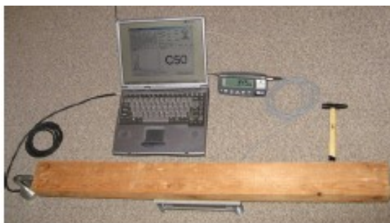
Ilustracja 4. Ważenie całej kłody. Zalecany tryb do obsługi krótkich kłód (poniżej 2m).
