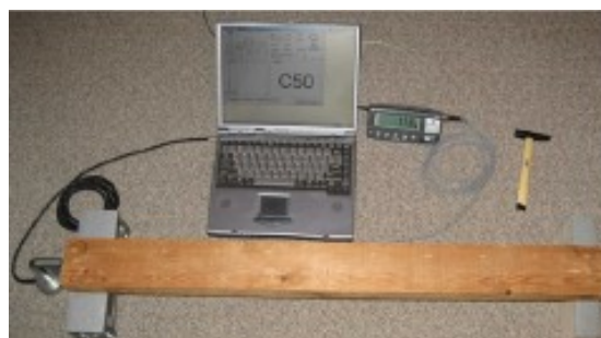
Ilustracja 5. Ważenie połowy kłody. Konfiguracja zalecana do obsługi długich kłód ( l > 2m ).
