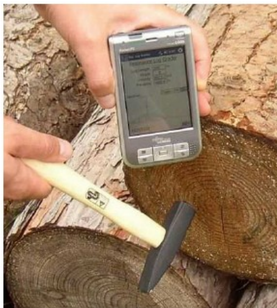
Rezonansowy klasyfikator jakości kłód podczas pracy
