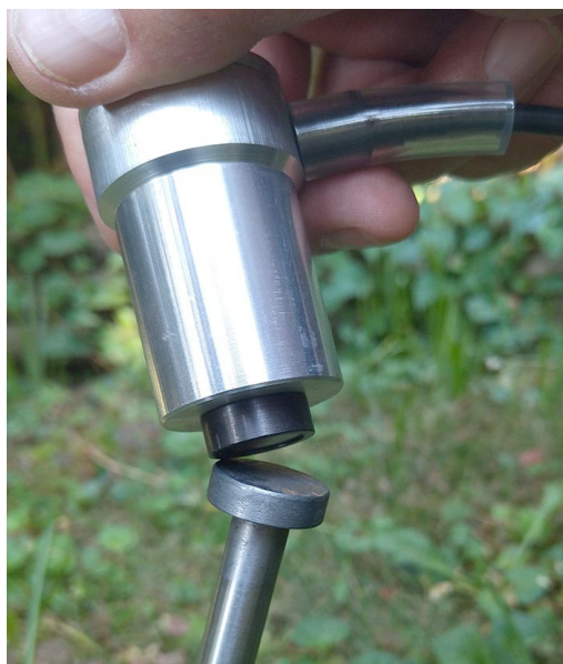
2. ábra: Talajszonda: a mágneses fejet óvatosan helyezzük a tűskére
