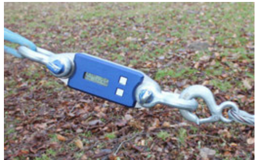
3.7. ábra: A kábel és a heveder közé helyezett erőmérő (Argus Electronic GmbH)
