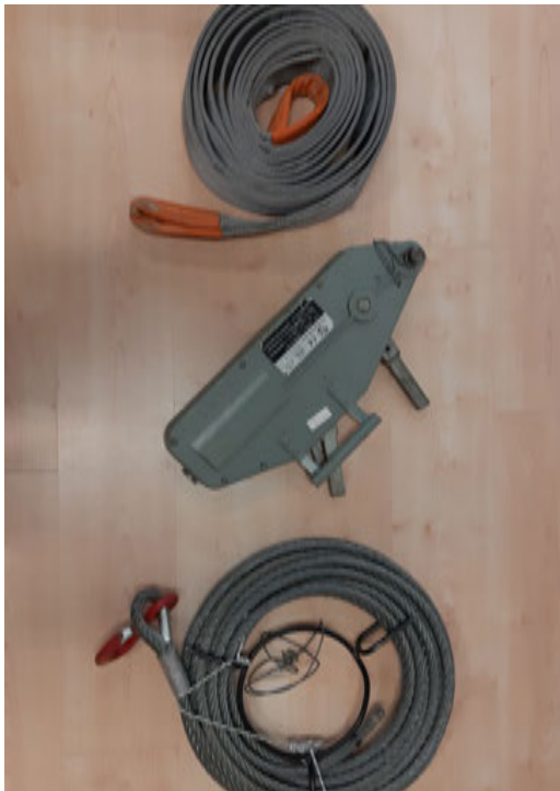
3.3. ábra: A húzóerő kifejtéséhez használt kábel, vonszoló és heveder
