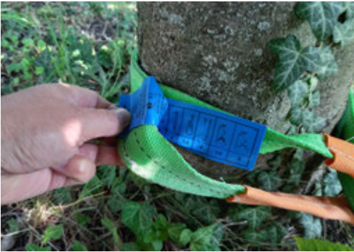
3.5. ábra: A heveder teherbírásának ellenőrzése
