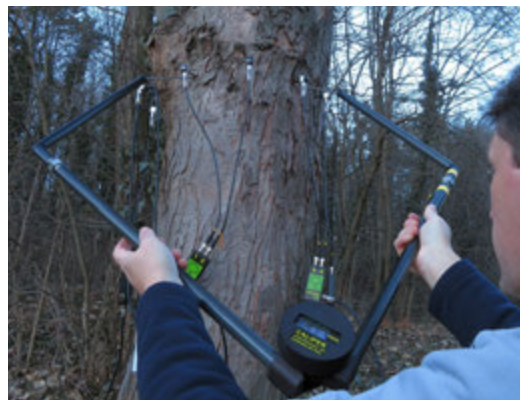
2.19. ábra: Elektromos átlaló használata
