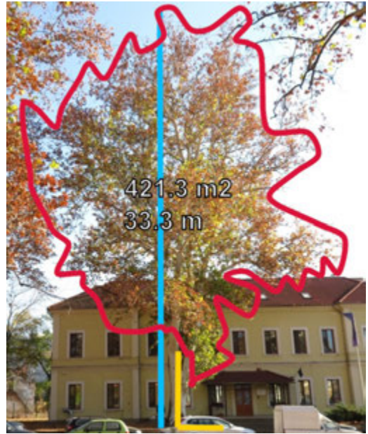
3.26. ábra: A fáról készült kép, a korona kontúrjának (piros), és a referencia magasság (a fa magassága, kék) megjelölésével
