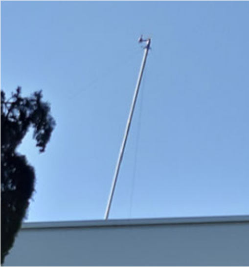
3.37. ábra: Épület tetejére telepített anemométer
